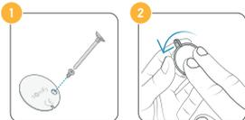
Rimuovere la vite e il coperchio del Key Fob, quindi sostituire la pila (1 da 3 V al litio Panasonic o Energizer CR2032).
