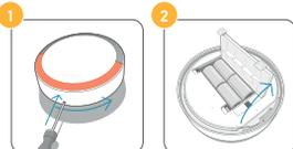
Disattivare l'autoprotezione<sup>(1)</sup> e rimuovere la sirena dal muro aiutandosi con un cacciavite (tenere premuto e girare nel senso della freccia). Aprire il coperchio del vano batterie e procedere alla sostituzione (4 da 1,5 V alcaline D).
